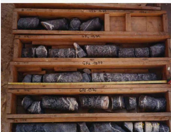
FIG IV-12 : Zone de faille avec de la brèche
