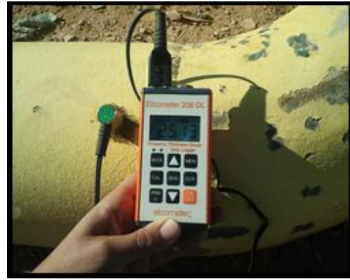
Figure II.8 : Mesure d'épaisseur par l'ultrason
