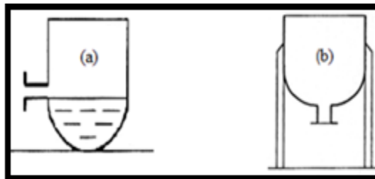
Figure I.7 : Vidange incomplète (a), et incomplète (b) du récipient
