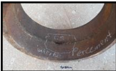
Figure II.4.3 : Percement du cordon soudure (vue interne)
