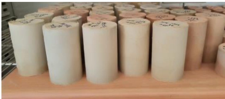
Photo(III.1) des éprouvettes de compression préparées à l'écrasement
