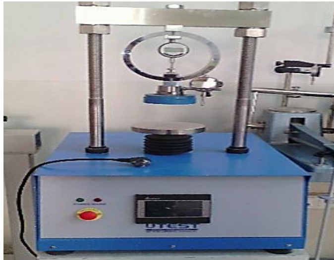
Photo(III.2) presse hydraulique pour l'écrasement
