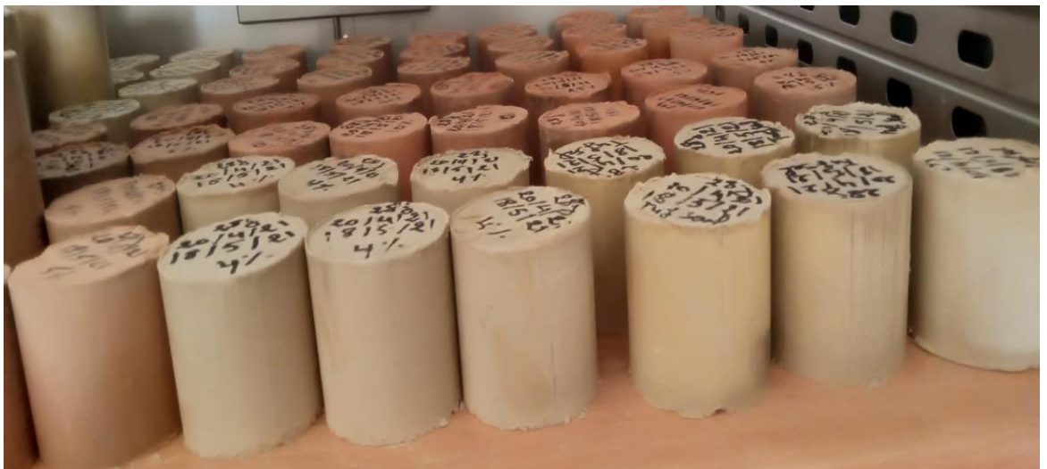
Photo(III.4) des éprouvettes de traction préparées à l'écrasement
