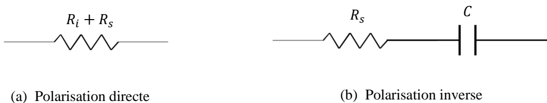
Fig.2.8 —Schéma équivalent d'une diode PIN en microondes.
