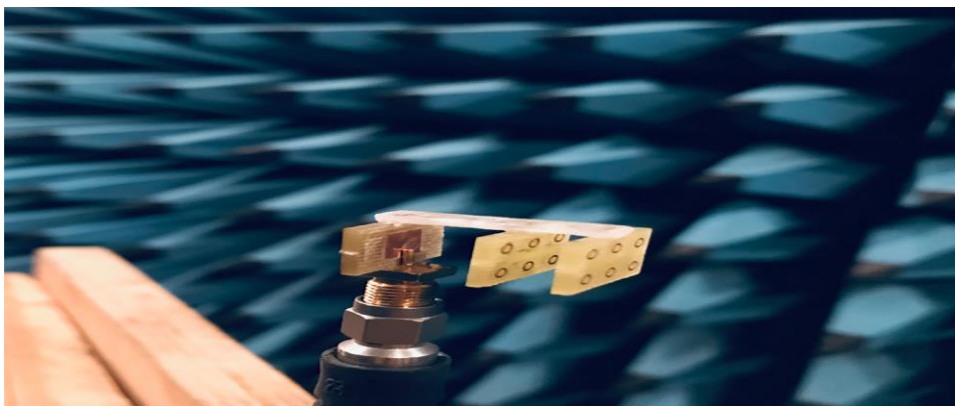
Figure I.16 : Prototype de l'antenne patch conventionnelle avec des couches de lentilles en métamatériaux dans la chambre de mesure [27].
