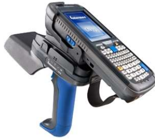
Figure 1.7 : Lecteur portable RFID, “intermecIP30”
