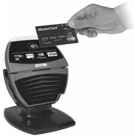
Figure 1.14 : Processus de paiement avec une carte à puce sans contact dans un terminal de point de vente POS.
