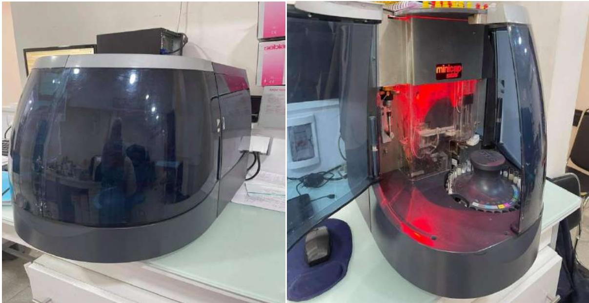
**Figure 11** : Electrophorèse capillaire sur automate MINICAP (SEBIA).
