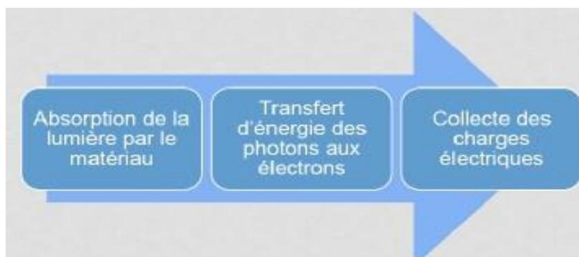
**Figure (1.4) :** les trois mécanismes de transformation de l'énergie solaire en une énergie électrique
