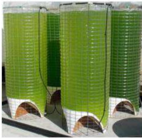
Figure 06: Exemple d'un système fermé (bioréacteur) de culture d'algue .
