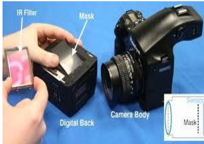
*Figure (1.10): capture des champs lumineux multiplexés en fréquence en plaçant un masque hétérodyne à proximité du capteur.*
