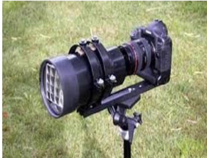
*Figure (1.9) : capture des champs lumineux multiplexés spatialement à l'aide d'un réseau de lentilles et de prismes.*
