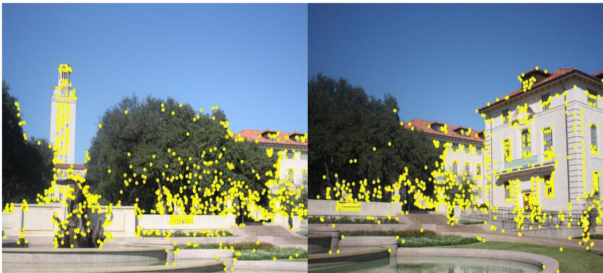
Figure III-14 : Points d'intérêt détectés de la quatrième scène à l'aide du détecteur FAST.
