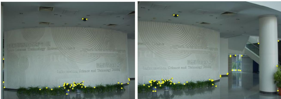
Figure III-5 : Points d'intérêt détectés de la première scène à l'aide du détecteur FAST.
