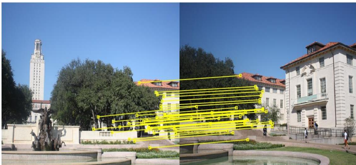
Figure III-15 : Points d'intérêts associés entre les images par l'algorithme flou de 4 ème scène.
