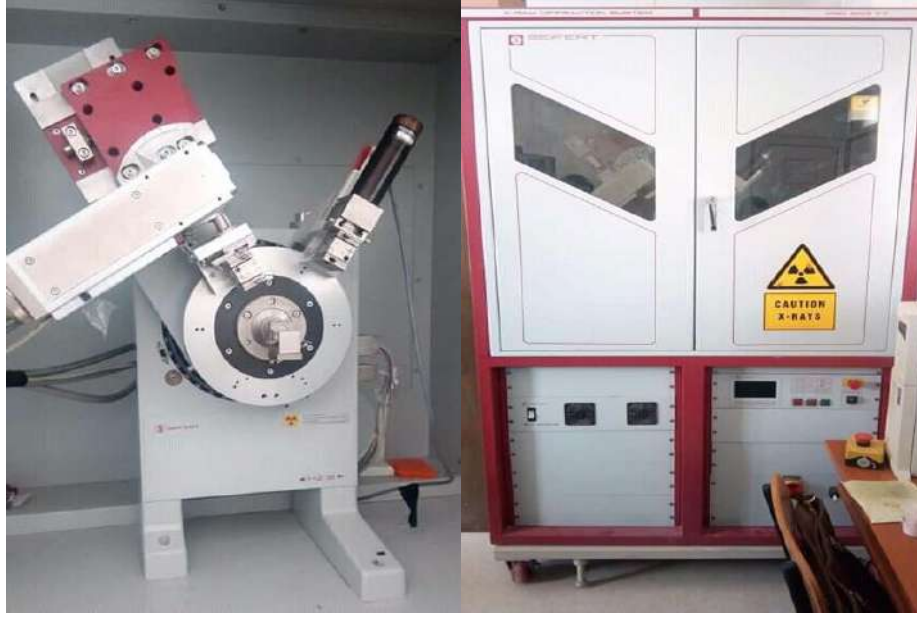
الشكل (IV-15): جهاز إنعراج الأشعة السينية المستعملة لدراسة العينة.
