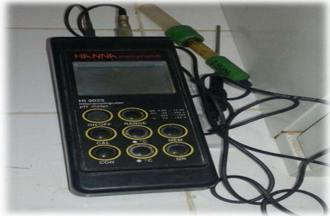
الشكل (III-8): مقياس pH من نوع HANNA
