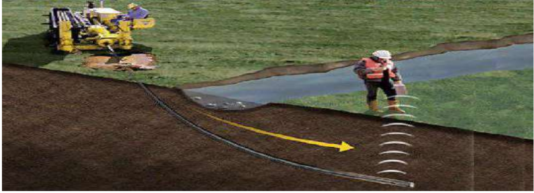
الشكل (6-II): مخطط جيولوجي يوضح الحفر الأفقي باستعمال الأمواج الصوتية
