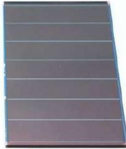
**Figure I.7** : cellule en silicium amorphe [4]
