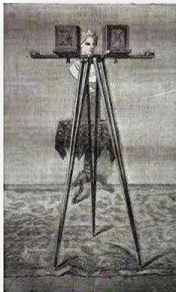
Figure II .8 : Deux caméras utilisées pour la prise de vue en stéréoscopie [musée dessciences 1860]
