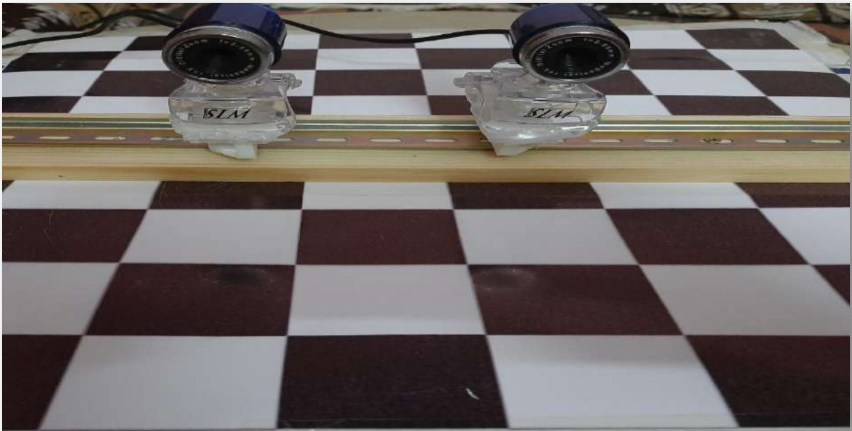
Figure III.3 : Caméras Web et échiquier utilisés pour le calibrage.
