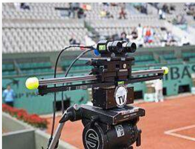
Figure II .10 : Caméra stéréoscopique, Roland Garros 2008.
