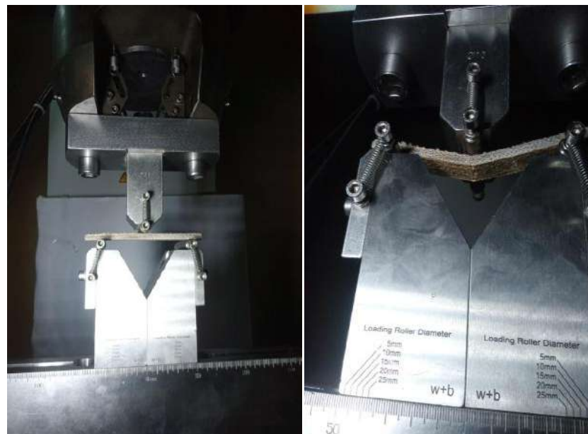
Figure III.12 : Essai de Flexion sur le composite jute/polyester.
