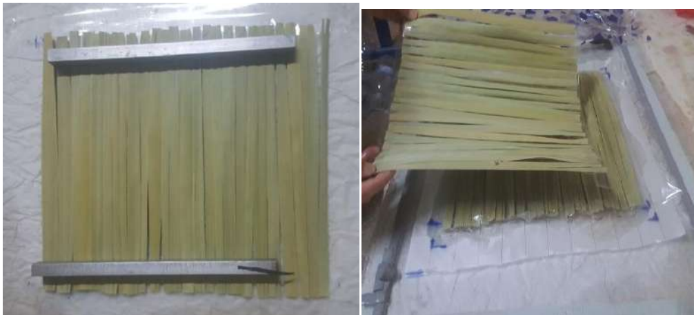
Figure III.3 préparation de plaques stratifiées
