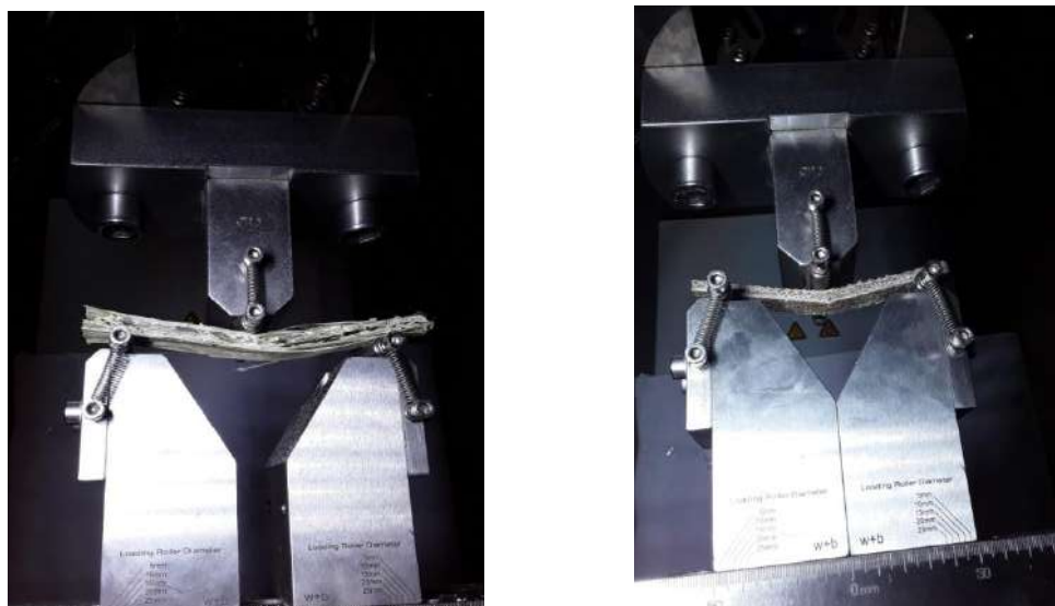
Figure III. 22 Essai de flexion a) éprouvette folioles de palmier dattier/polyester b) éprouvette jute/polyester
