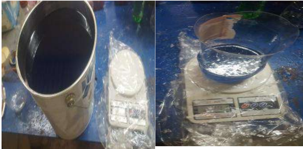
Figure III.4 Préparation du mélange (résine + durcisseur)
