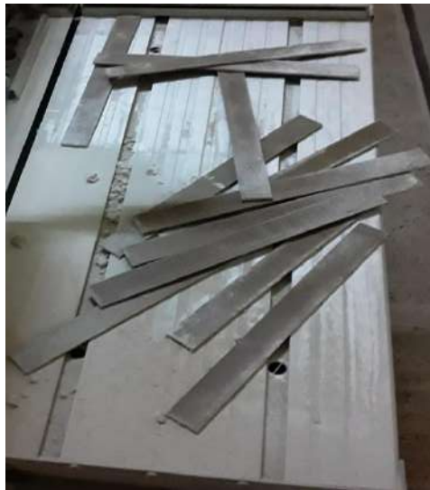
Figure III.7b Eprovettes utilisées en traction : Composite stratifié jute/polyester
