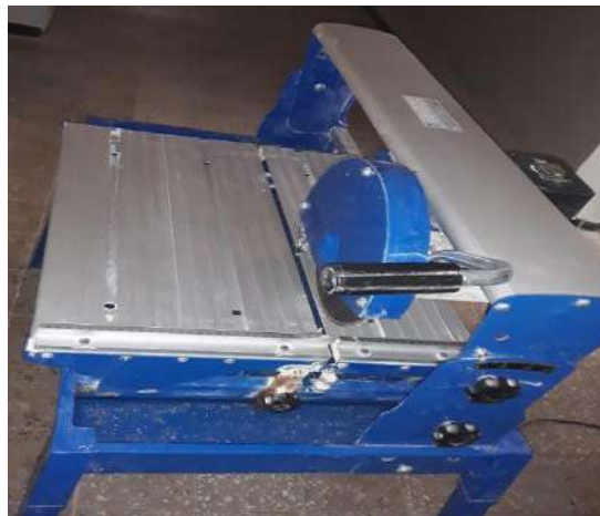
Figure III.6 Tronçonneuse à disque diamanté utilisée pour le découpage des plaques biocomposites
