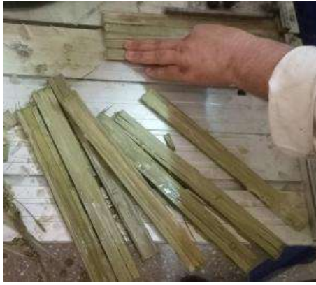
Figure III.7a Eprovettes utilisées en traction : Composite stratifié folioles palmier dattier/polyester
