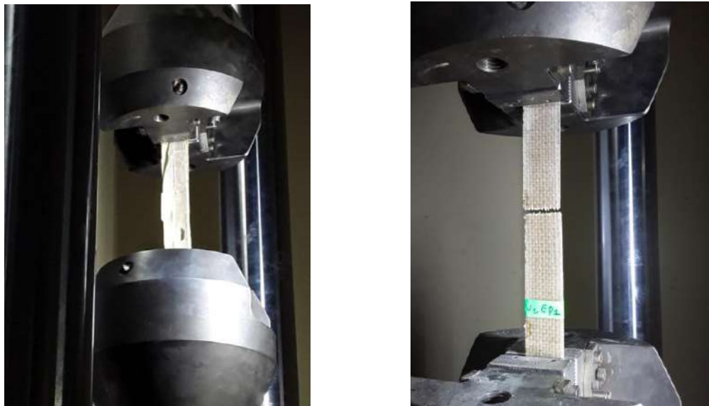
Figure III. 17 Essai de traction a) échantillon folioles de palmier dattier/polyester b) échantillon jute/polyester
