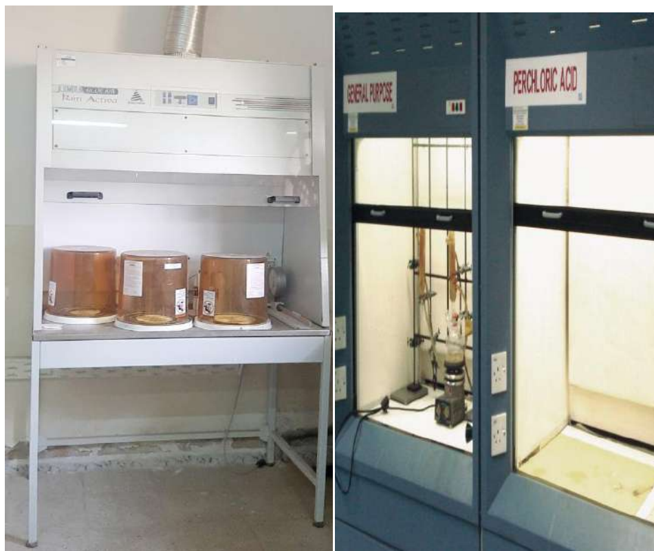
Figure 4 : Exemples des hottes de laboratoire[3].
