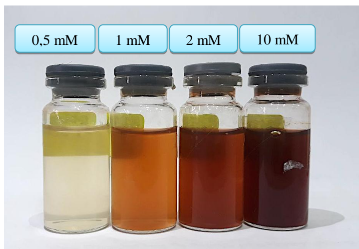
Figure III.4: Effet de la concentration de \text{AgNO}_3 sur la formation des AgNPs.
