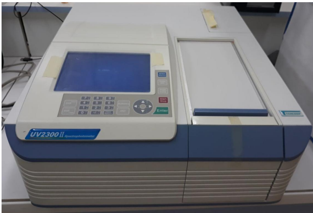
Figure II.3: Schéma de l'appareil spectrophotomètre ultraviolet (SP-UV 2300 II)
