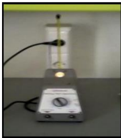
Figure III.8 : Schéma d'appareil point de fusion
