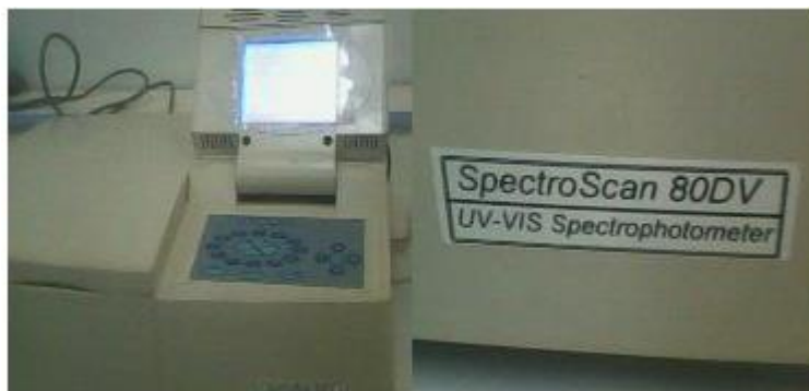
Figure III.1 : Spectrophotométrie d'absorption moléculaire UV-visible
