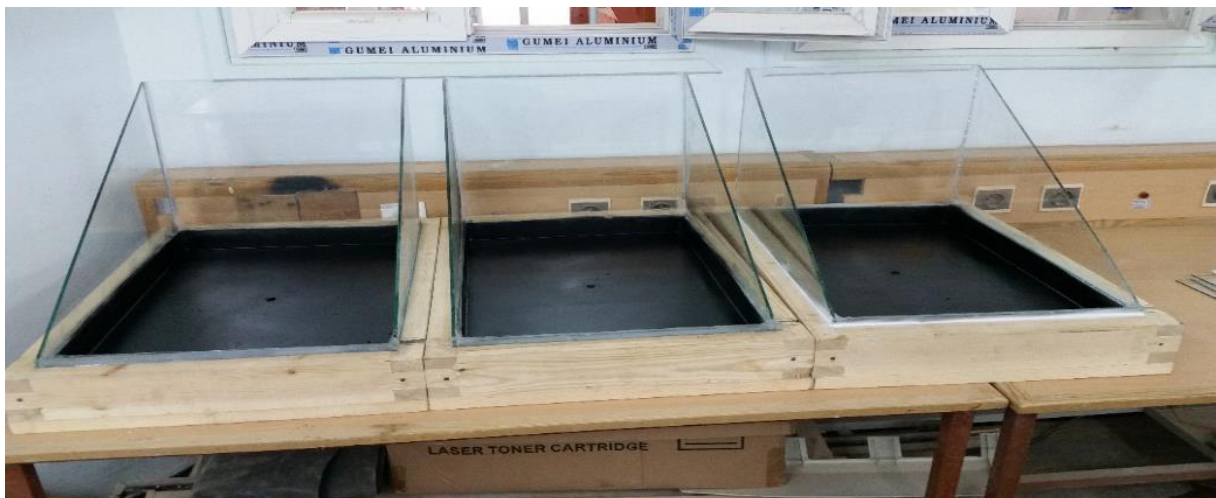
Figure II-1: Conception du distillateur solaire.
