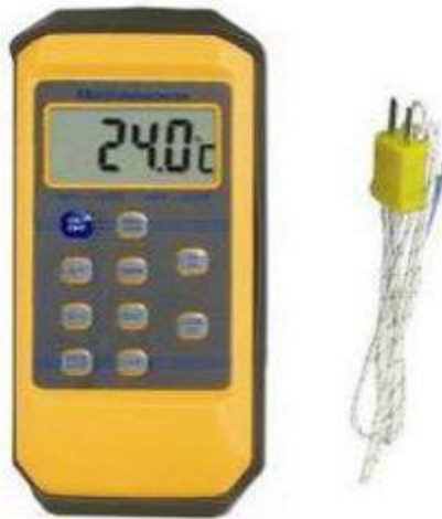
Figure 4: Appareil de Mesure de la température (thermocouples).
