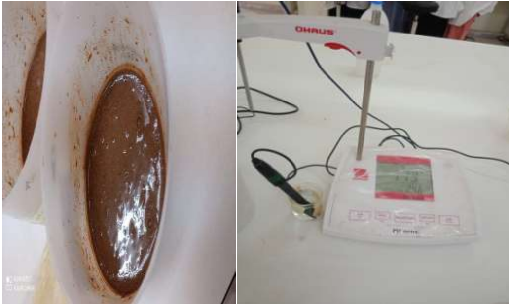
Figure N° 07: Préparation de la pâte saturée Figure N°08 : Mesure de PH
