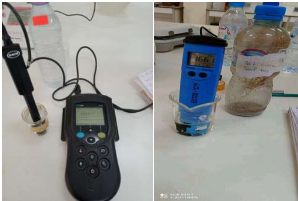
Figure N°06 : Mesure de la conductivité électrique
