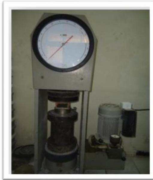
**Figure II.09: Essai de compression**
