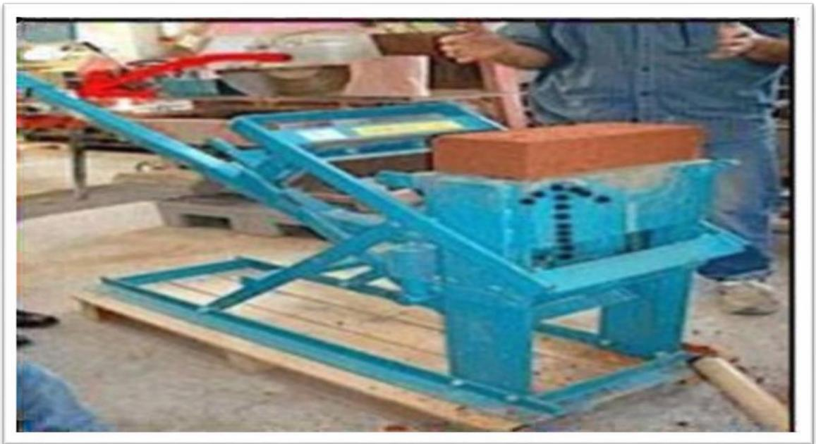
**Photo I.4 : Bloc de terre crue compressée réalisée à l'aide d'une presse**
