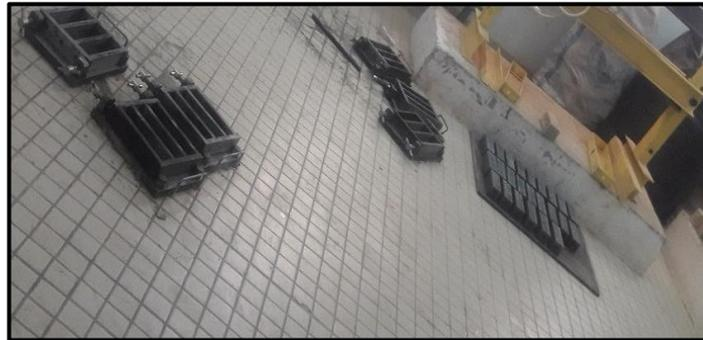
**Figure II.12 :** Démoulage des éprouvettes
