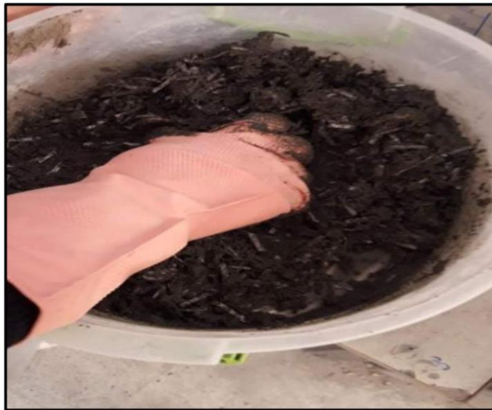
**Figure I.8 :** Mortier fibré.
