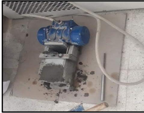
Figure II.9 : La maniabilimètre
