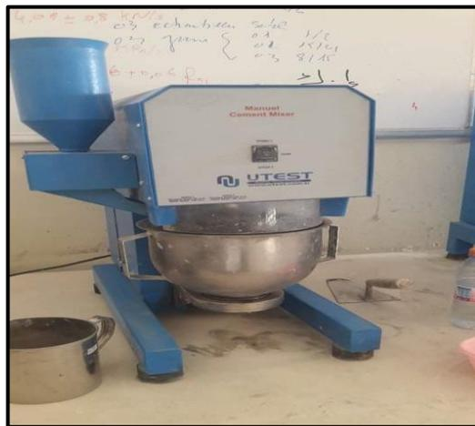
**Figure II.8 :** Malaxeur de mortier
