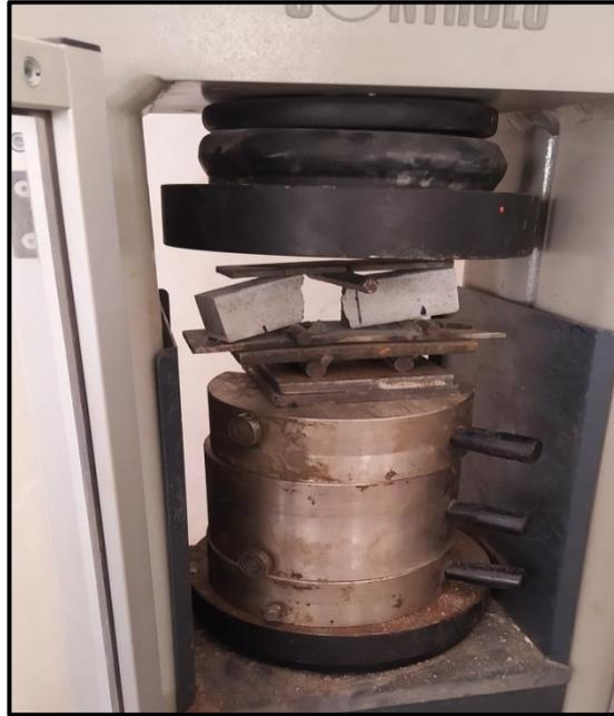
Figure III.2 : Essai de la résistance a la flexion
