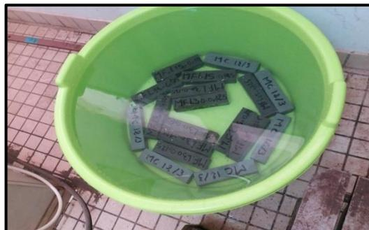
**Figure II.13 :** Conservation des éprouvettes dans l'eau
