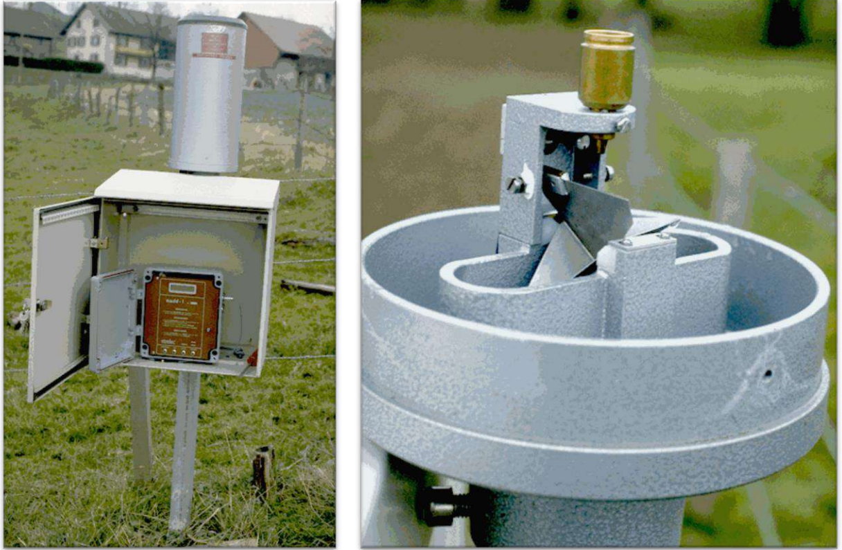
Figure II.5 : Exemple d'un pluviographe à augets basculeurs et système d'enregistrement
