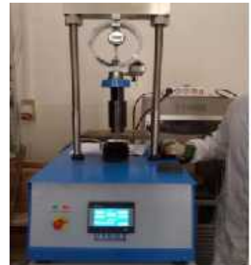
b) Chargement de compactage 41.9 kN
