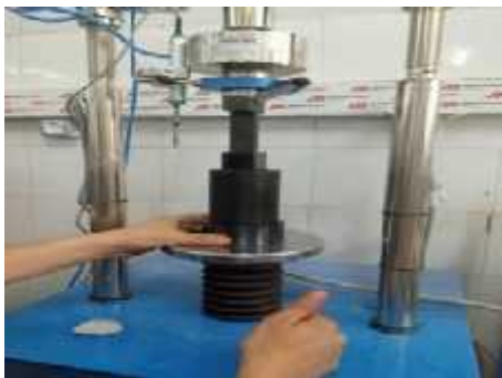
a) Opération de démoulage
