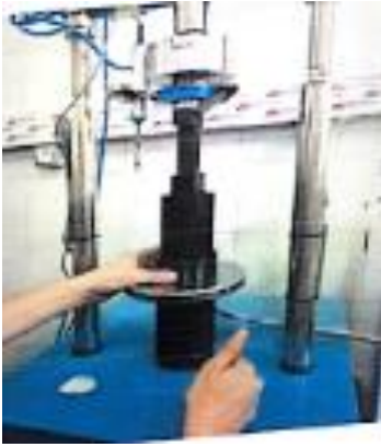
Figure (15) : Opération de démoulage
