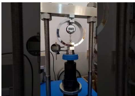
a) Confection d'une éprouvette par la presse d'essai
