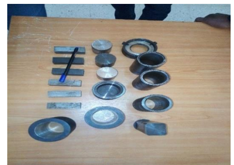
b) Equipements de l'essai (moules, hausse, piston)
