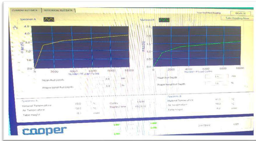
- الصورة رقم (42) واجهة برنامج جهاز اختبار التحدد -
