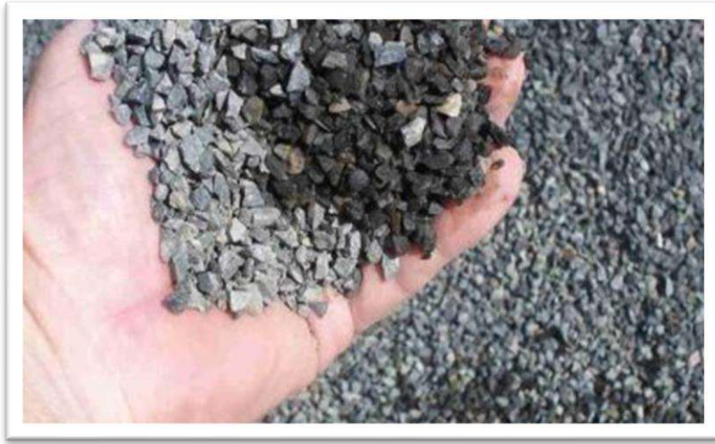
- الصورة رقم (7) للمواد المضافات في الخلطة البيتومينية -
