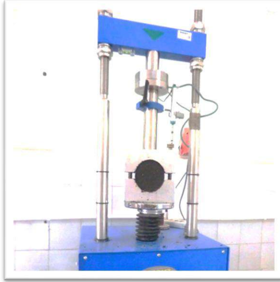
- الصورة رقم (36) لجهاز اختبار مارشال -
