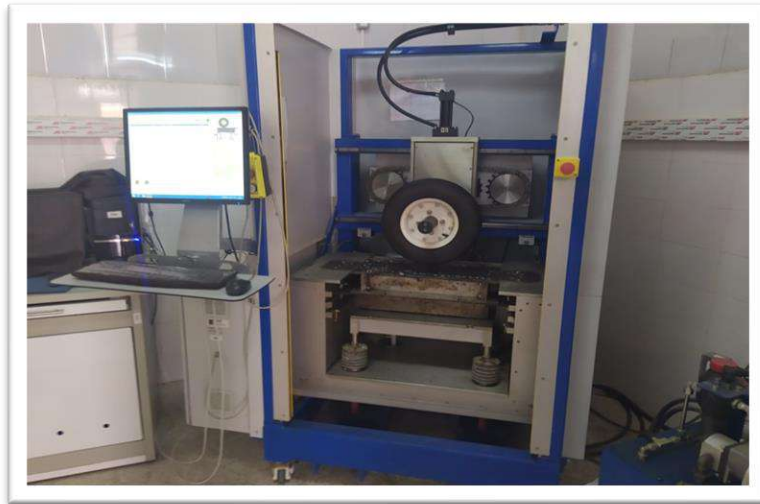
- الصورة رقم (40) جهاز دمك اللوحات قبل اختبار تحدد -
