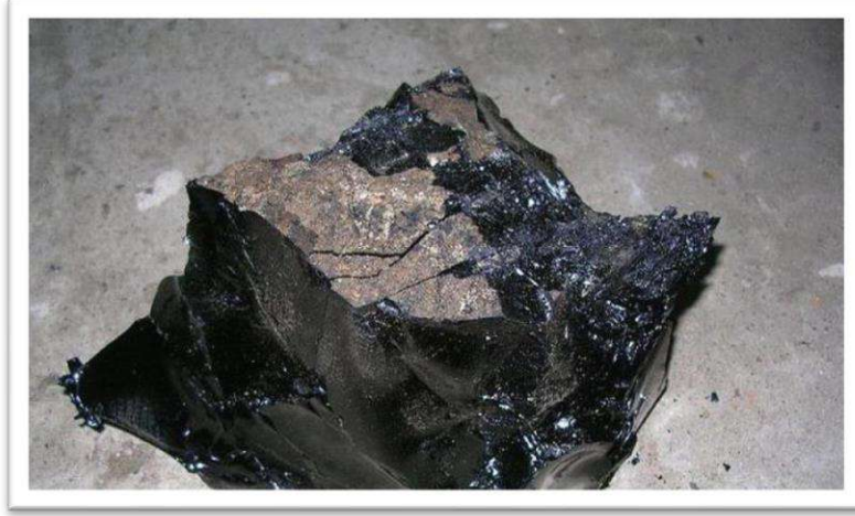
- الصورة رقم (6) المادة البيتومينة الرابطة في حالتها صلبة -
