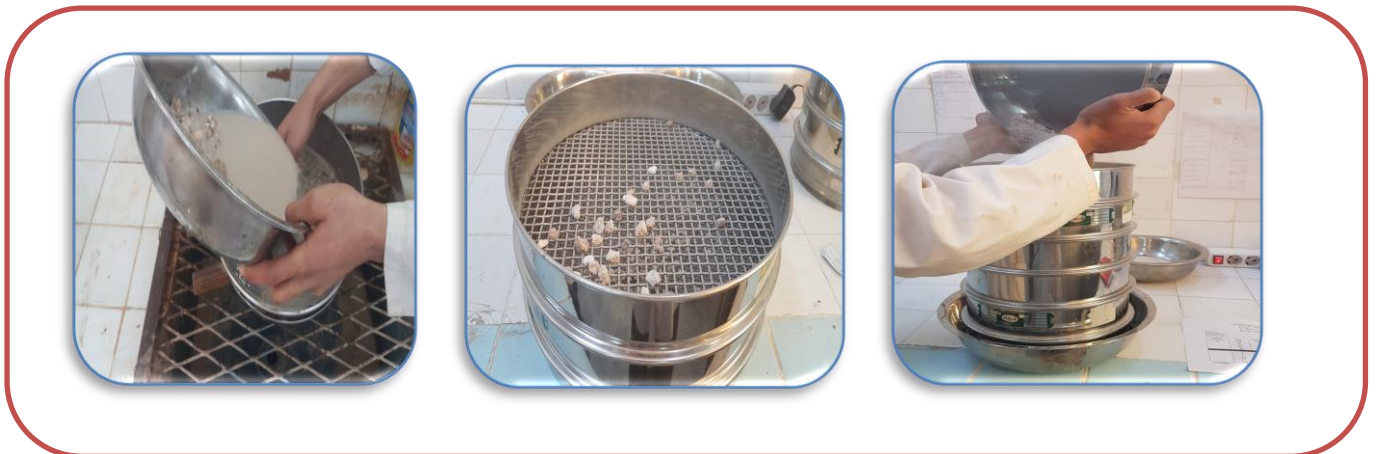
Figure II.1 Essai d'analyse granulométrique par tamisage.
