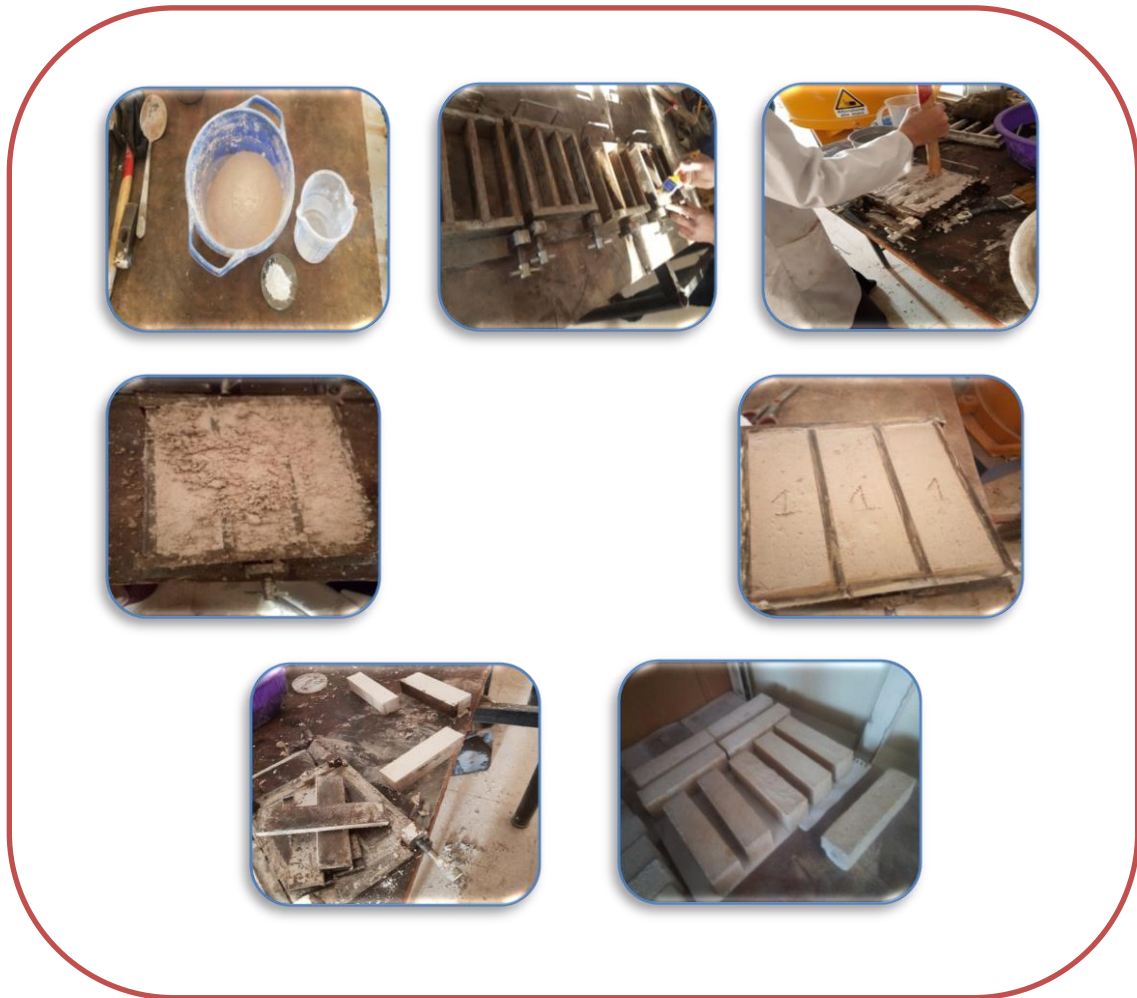
Figure III.1 Les étapes de préparations des éprouvettes.
