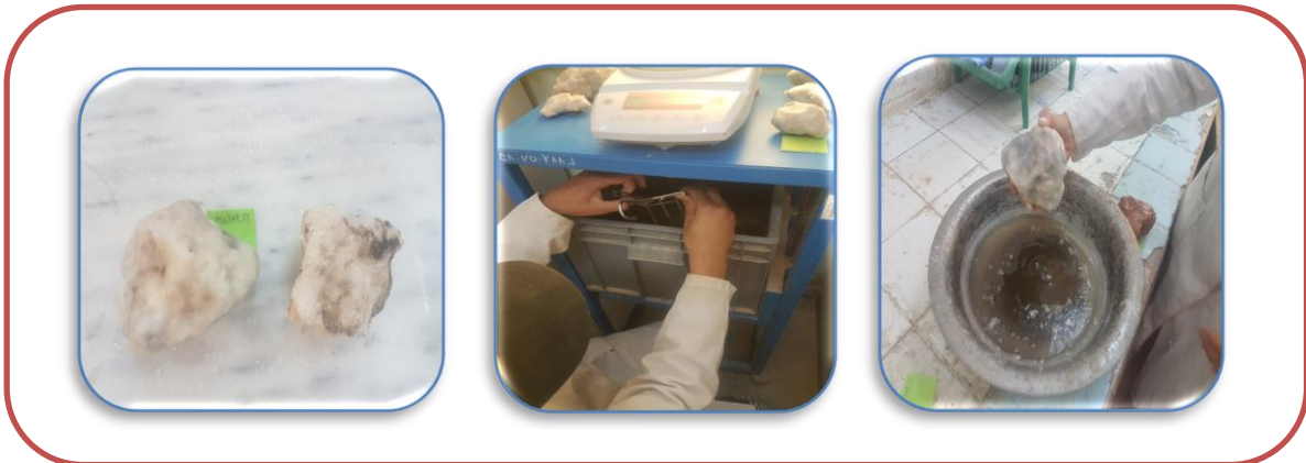
Figure II.7 Essai de la densité naturel.
