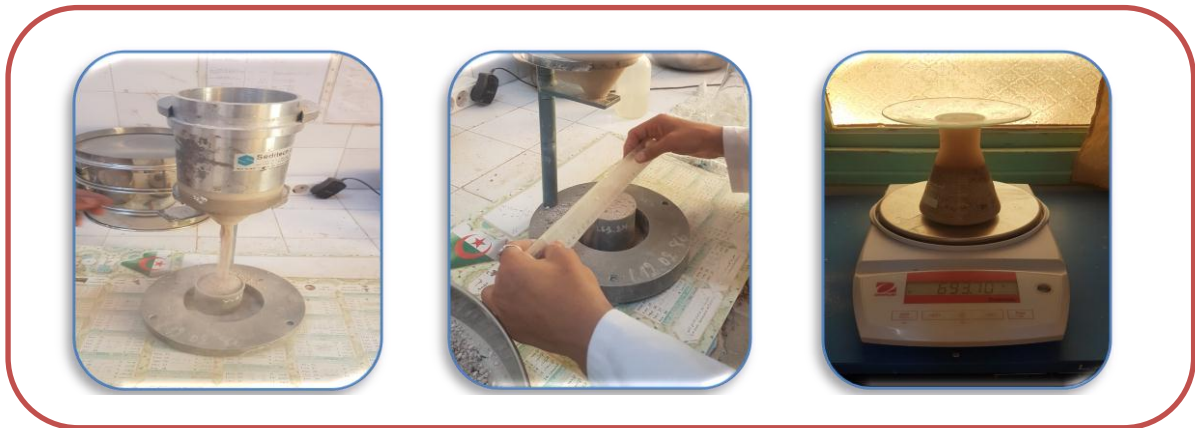
Figure II.3 Essai de la masse volumique apparente et absolue
