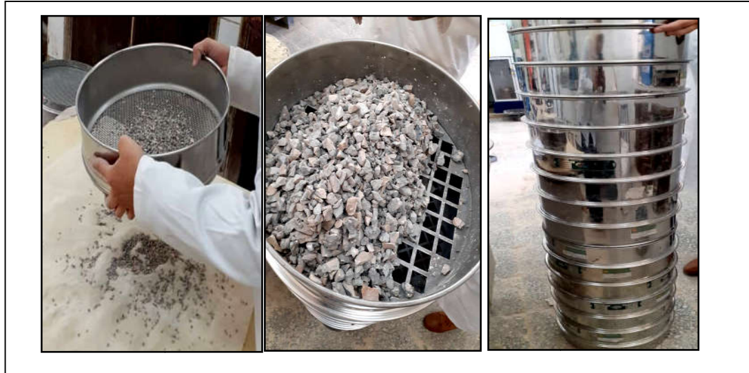
Figure II- 1: opération de tamisage manuelle.
