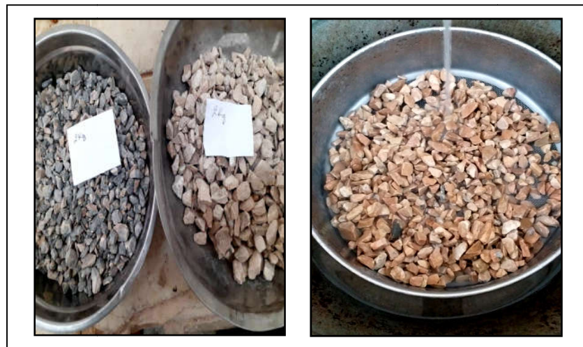
Figure II- 7:essai de propreté des graviers utilisent.
