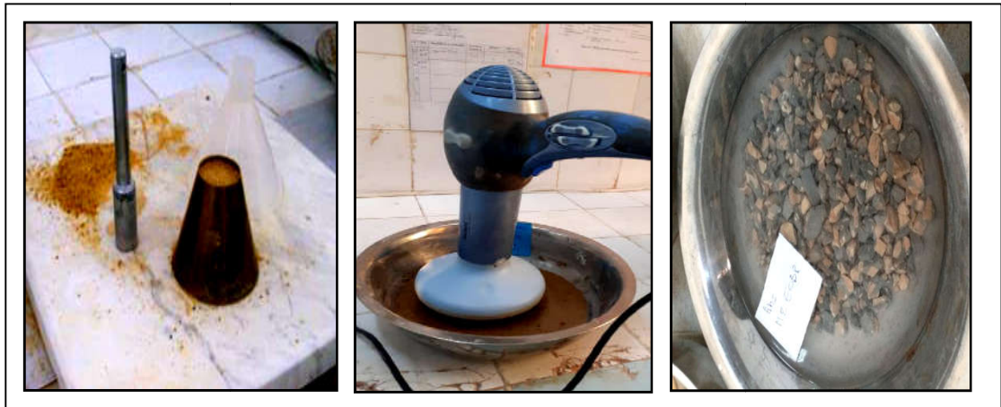
Figure II- 6: essai d'absorption d'eau des différents matériaux.
