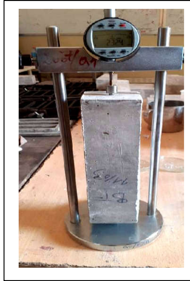
Figure II- 15: essai de retrait de béton.
