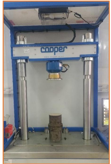
Figure II.14 : Machine d'essai de compression.
