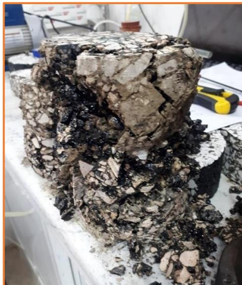
**Figure III.22 : Eprouvettes après l'écrasement.**
