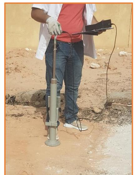
Figure II.10 : Vues de détail du compactomètre de Clegg
