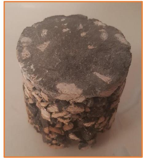
Figure III.6 : Eprouvette après le surfacage.
