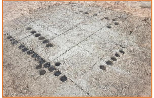
**Figure III.8 : Planche d'essai après le découpage.**
