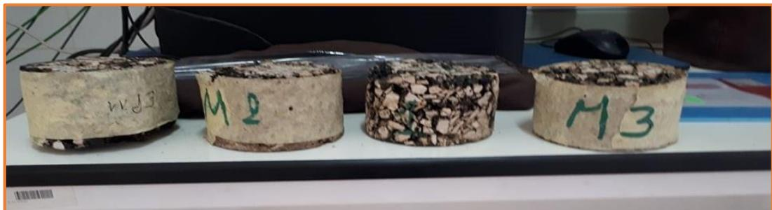
**Figure III.23 : Les éprouvettes de l'essai du module de rigidité.**
