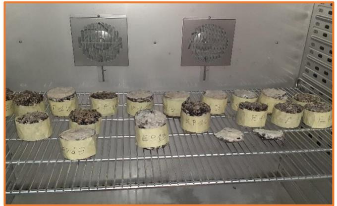
**Figure III.2 : Éprouvettes après carottage.**
