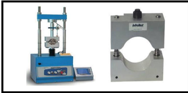
**Figure (II.7): Machine d'essai Marshall [15]**
