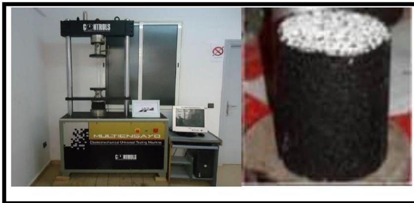
**Figure (II.8) : Machine d'essai Duriez [16]**
