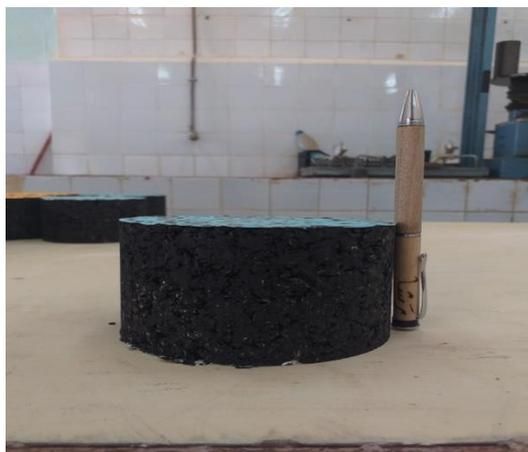
**Photo (VI.5): Exemple d'éprouvettes Marshall.**
