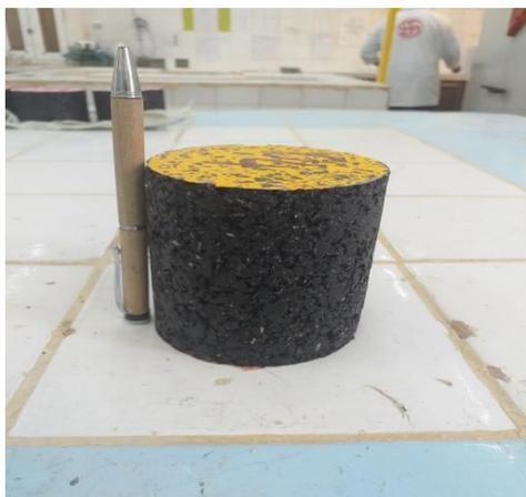
**Photo (VI.6): Exemple d'éprouvettes Duriez.**
