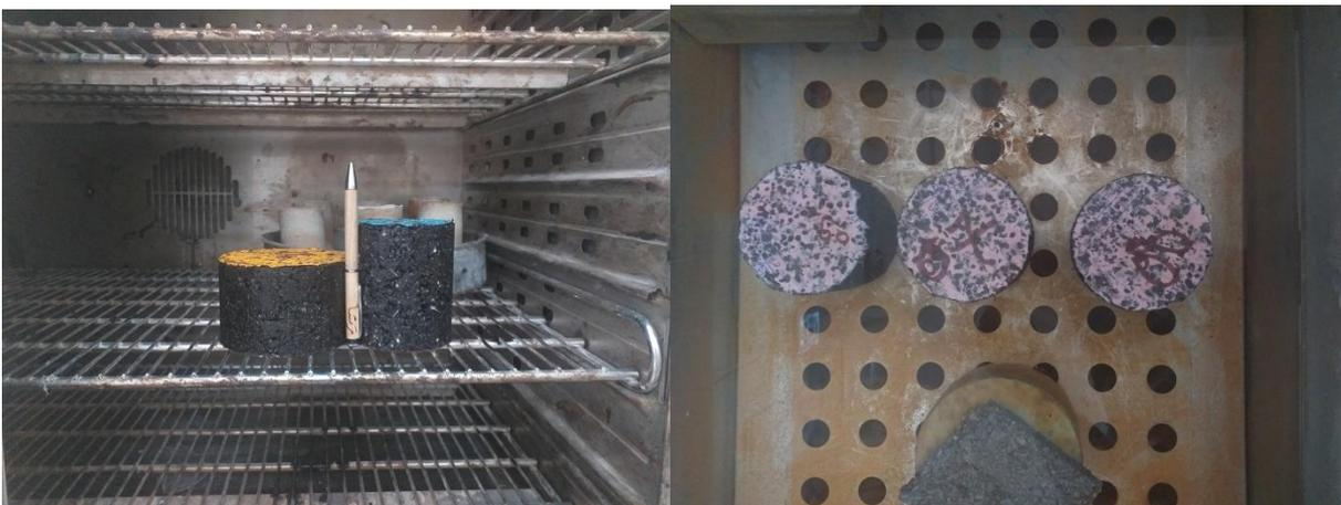
**Photo (VI.7) : conservation des éprouvettes Marshall et Duriez.**
