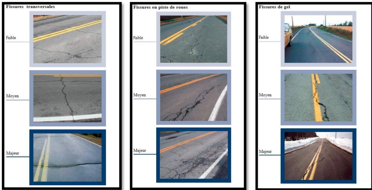
Figure (III.2) : Dégradations des chaussées par fissurations. [19]
