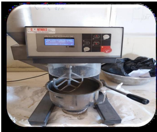
Photo 2.8.1 : Malaxeur de mortier
