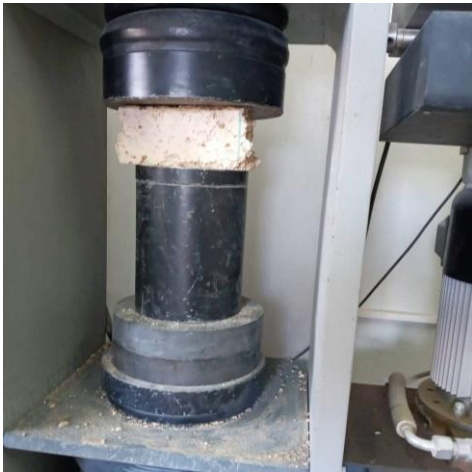
Photo N°9 : Essai de compression.
