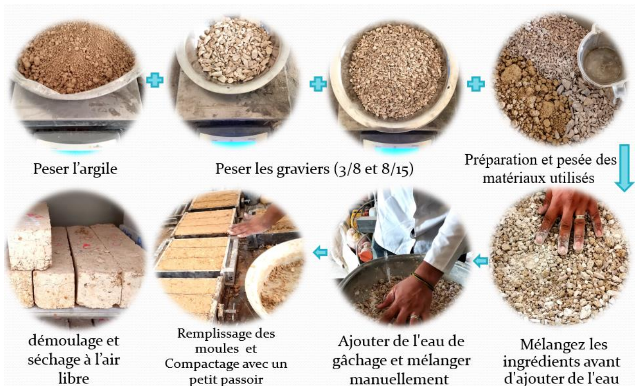
Figure III.3 : Schéma de préparation des échantillons utilisés dans l'étude.
