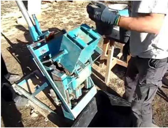
Figure I.5 : Fabrication de BTC.
