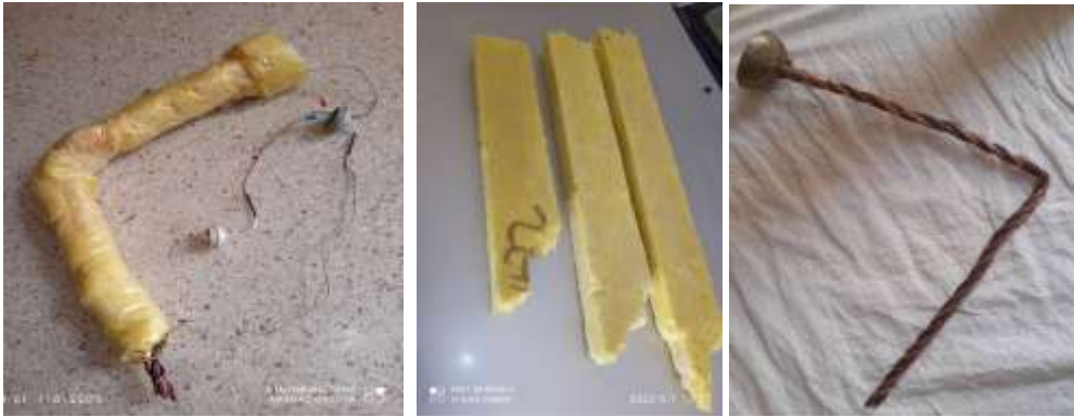
الشكل(4-III): صور لقضيب نحاسي و كيفية عزله.
