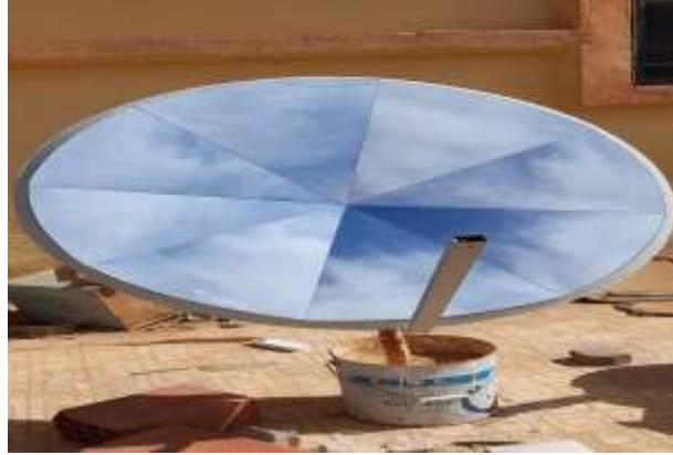
الشكل(1-III): صورة لمجمع الصحن القطع المكافئ (DP) المنجز.
