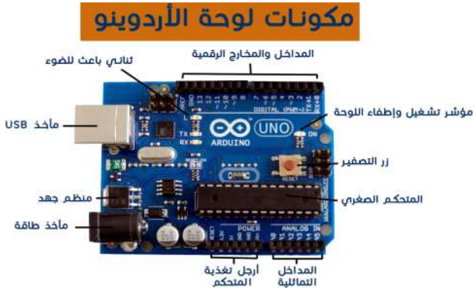
الشكل (III-9): صورة توضح لوح اردوينو ومكوناته [25].
