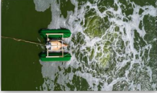
الشكل (17): جهاز تهوية عن طريق نفخ الهواء
