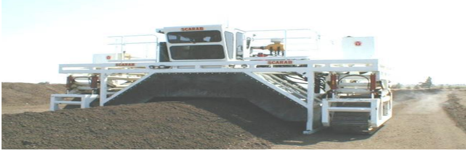
الشكل (10): شكل مصفوفة الحمأة وعمليات التنقيب الميكانيكي
