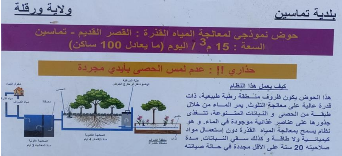
الشكل (11): مراحل المعالجة على مستوى محطة تماسين - ولاية تفرت
