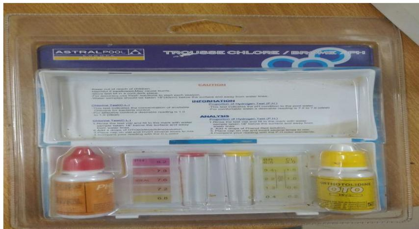
Figure : Un appareil utilisé dans la piscine pour mesurer les niveaux de pH, de chlore et de brome de l'eau de la piscine.
