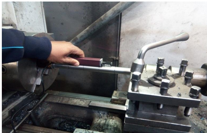
Figure III.6 : Principe de mesure de la rugosité.
