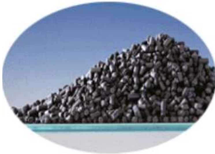
Figure III :4 : charbon actif extrudé
