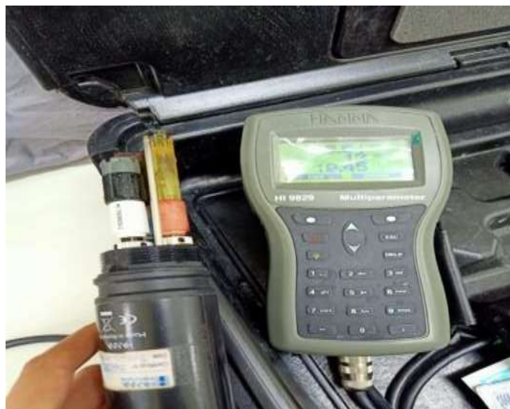
Figure IV 3 : Multi Paramètres pour mesurer Cond, T° et pH.
