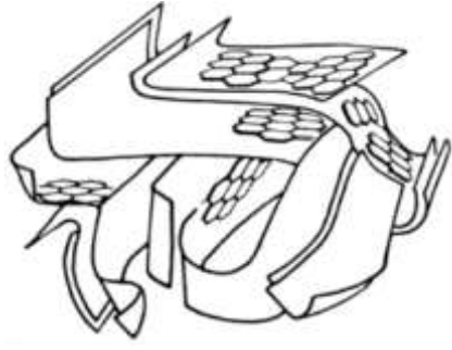
Figure III 7: Représentation de la microstructure d'un charbon actif
