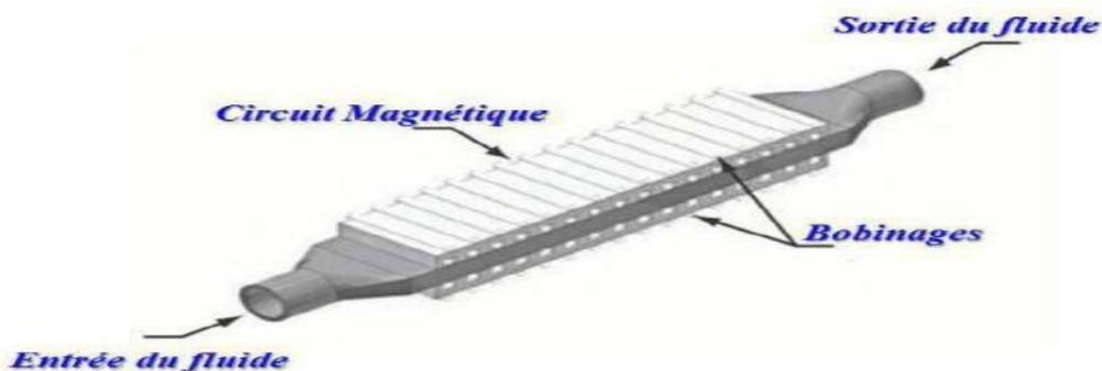
Figure (I.6) pompe MHD à induction plate
