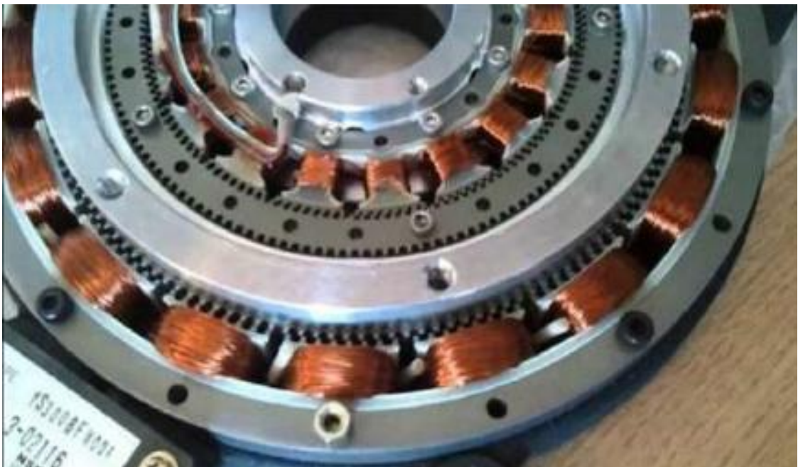
Figure I - 14 : MRV à effet Vernier à stator externe et interne [16].
