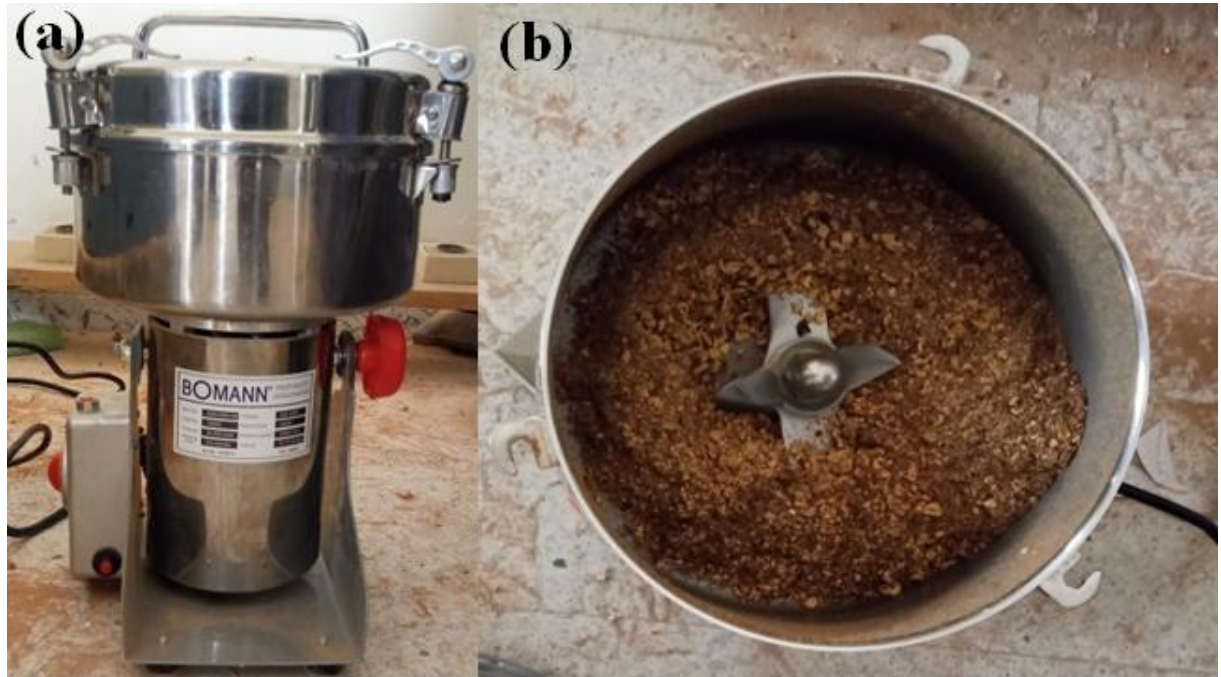
Figure 45 : Mouture du noyau d'olive a) broyeur de type YUNINLI 400g et
