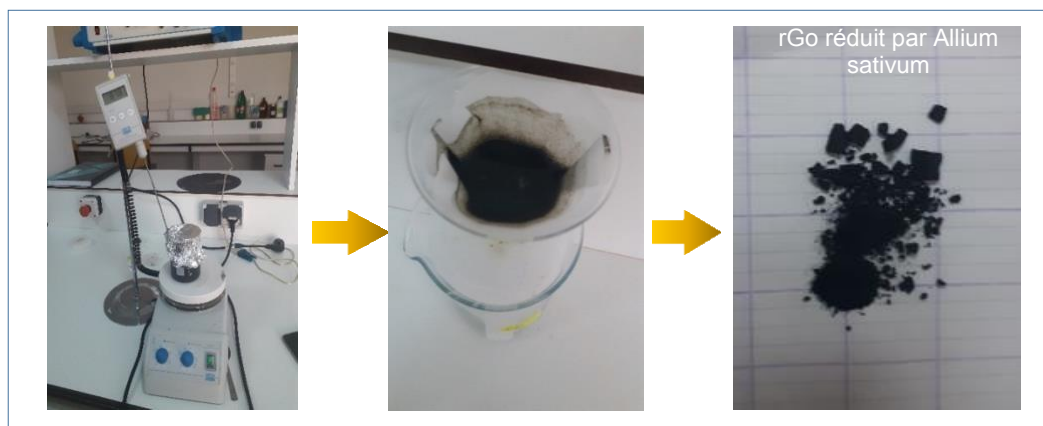
Figure. II.3 Étapes de préparation de l'oxyde graphène réduit par la plante Allium Sativum .
