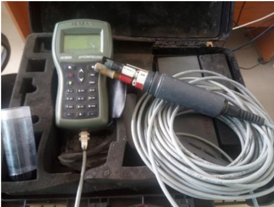
Figure I. 1. Instrument de mesure multi paramètre de terrain [1].
