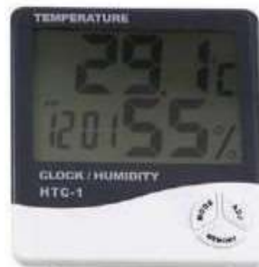
Figure 3: Appareil de mesure de la température ambiante.
