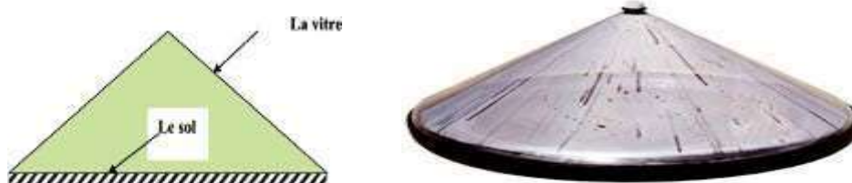
Figure I.3-3-4 Distillateur solaire terre-eau.
