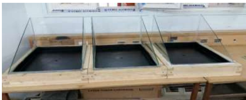
Figure II.2-1 Conception du distillateur solaire.
