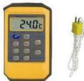
Figure 4 : Appareil de Mesure de la température (thermocouples).
