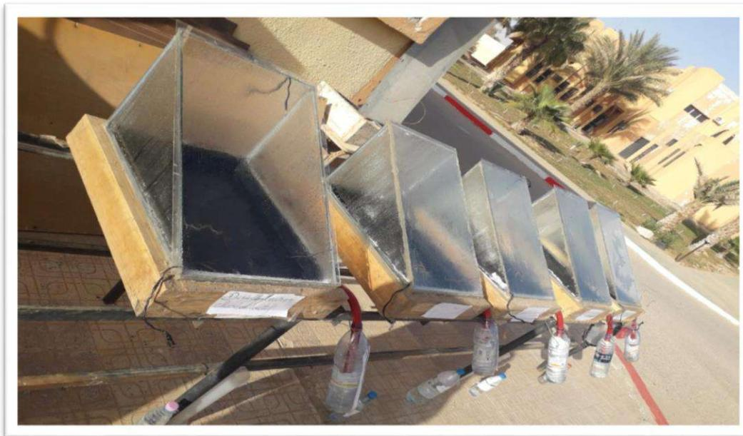
**Figure II.1** : Les distillateurs solaires sur le site des tests à l'université d'Ouargla.
