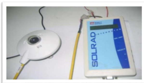
**Figure II.3 :** Solari-mètre.
