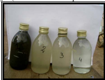
Photo 1 : Variation de turbidité des eaux de l'entrée à la sortie de la station.
