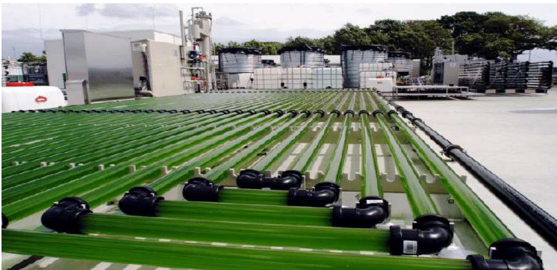
Figure 15 : Photobioréacteur tubulaire de l'Université de Wageningen Algae Parc (Nil 2016)
