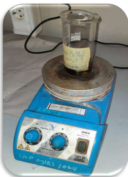
Figure (III-1) : Montage expérimental utilisé pour l'étude de l'adsorption des colorants sur charbon
