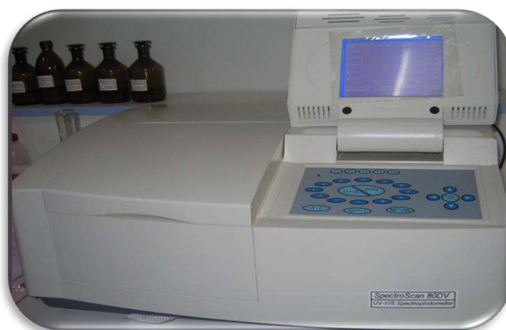
Figure (III-3) : Spectrophotomètre UV-Visible (Spectroscan 80D/80DV).
