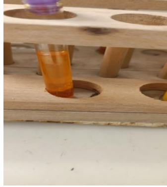
الشكل 7: نتيجة اختبار التتبع بدراجندروف أثناء عملية الاستخلاص
