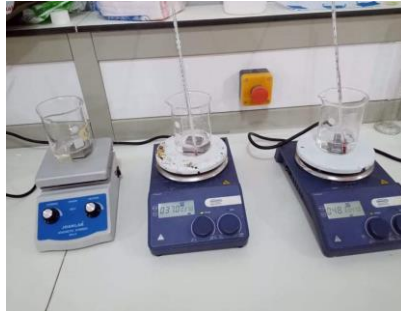
الشكل (5.II): صورة لعملية تآكل بطريقة فقدان الوزن
