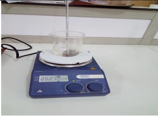
صورة لعملية التآكل بطريقة فقدان الوزن في وجود المثبط
